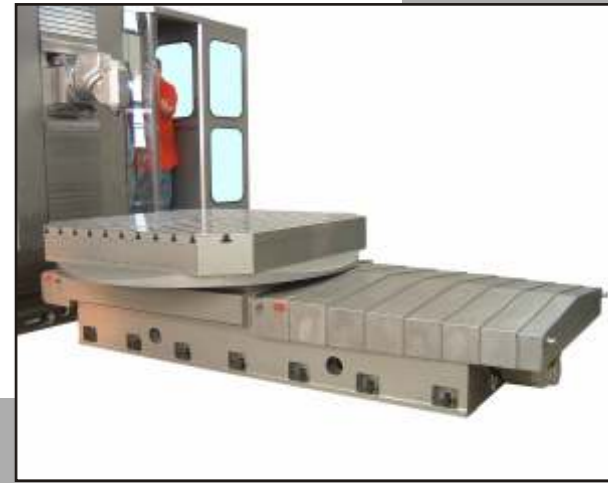
Tavole girevoli e rototraslanti Rotary and sliding tables CN-Drehtischen ist vorhanden und dabei Plateaux rotatifs et déplaçables
